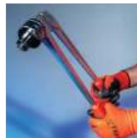
Ручной экспандер с расширительной головкой
